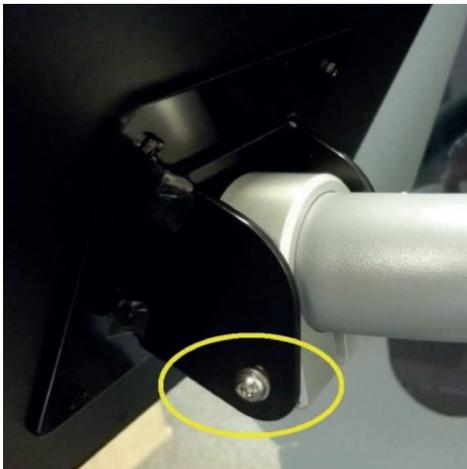
Abbildung 2: Montage der Klammer auf der Rückseite des Touchscreens
