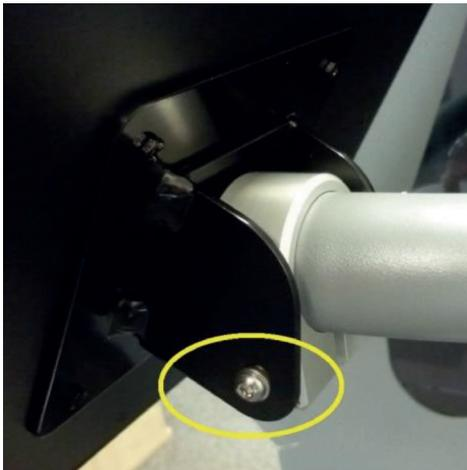
Figura 2: fijación del soporte posterior de la pantalla táctil
