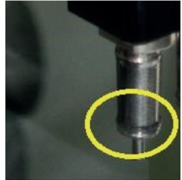
Figura 1: junta tórica de la sonda
