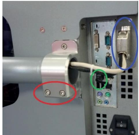
Figura 3: fijación de la pantalla táctil al equipo
