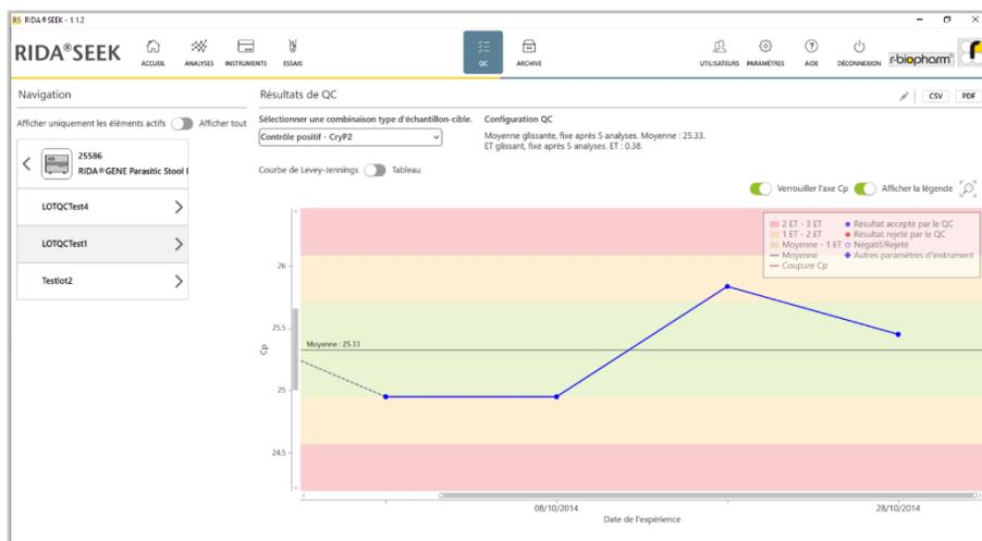
**Figure 40** : Module QC : aperçu des résultats du contrôle qualité.
