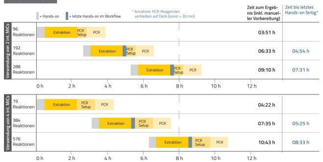
Je nach Probenaufkommen können mit RIDA®UNITY bis zu 3 Läufe oder bis zu 384 Reaktionen an einem Arbeitstag bearbeitet werden. Die Extraktion weiterer Proben kann gestartet werden, während die PCR noch läuft.
