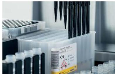
Die Extraktion von bis zu 96 Proben wird vollautomatisch durchgeführt
