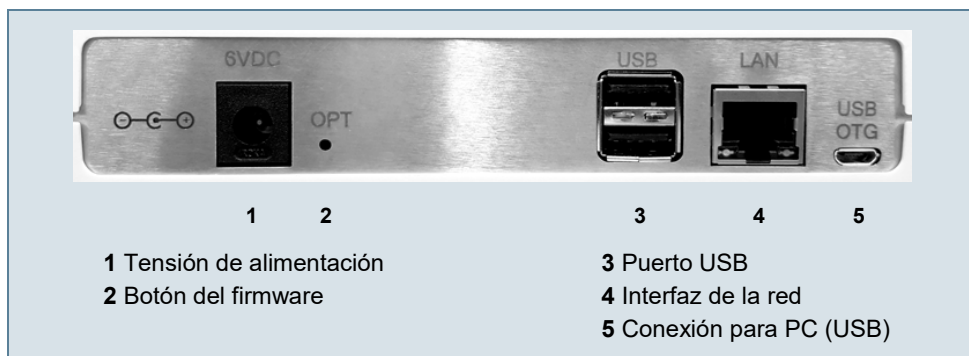
Fig. 2: Conexiones en la parte posterior del dispositivo
