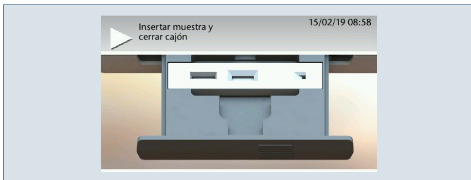
Fig. 9: Orientación correcta del casete de ensayo
