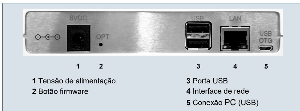
Fig. 2: Conexões na parte traseira do dispositivo
